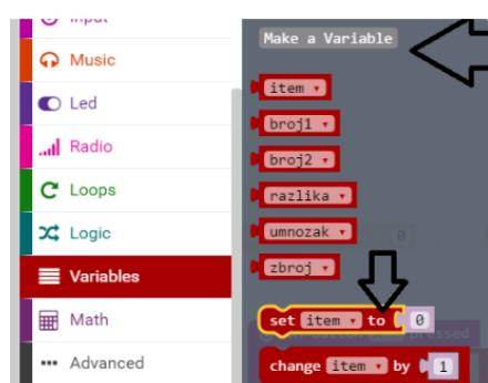
Potrebna su nam dva broja s kojima ćemo raditi te stoga dovučemo 2 naredbe set\_(ime varijable)\_to na radnu površinu i postavimo ih na 0. Nakon toga isprogramirat ćemo tipke A, B i A+B i to na sljedeći način:
