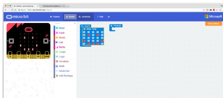
Simulator sa lijeve strane započeo je sa izvršavanjem programa i na virtualnom micro:bitu se iscrtao smješko. Ako nacrtamo drugačije lice, smiješak promjene će se odmah prikazati u simulatoru.
